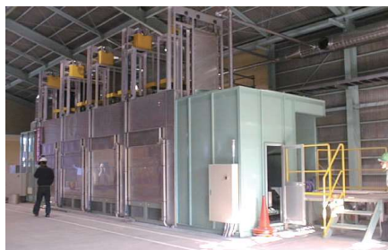
W13.5m×H5.5m×3.3m 大型自動搬送連続焼成炉
