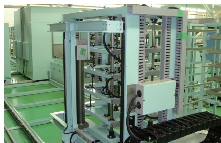
直交ロボット使用 無人自動搬送熱処理ライン
