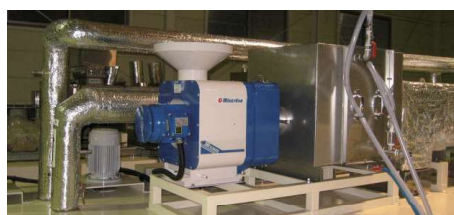
ミストレーサ、冷却ドレントラップ搭載、排気の清浄化
