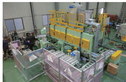
三軸スカラロボット使用 自動搬送式水分乾燥炉
